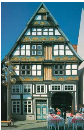
(Holz-) Fachwerk mit hell verputzten Gefachen steht in der Tradition der Typologie des Lipper Landes
